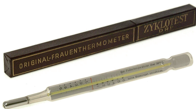
Abb. 3: Original-Frauenthermometer zur genauen Messung geringfügiger Temperaturveränderungen (1959). Das Anzeigespektrum reicht von 36,9°C plus 6 Zehntelgrade nach oben und nach unten. Aufschrift: Messungen des Morgens vor dem Aufstehen. Bei Fiebertemperaturen über 38°C keine Messungen vornehmen.
