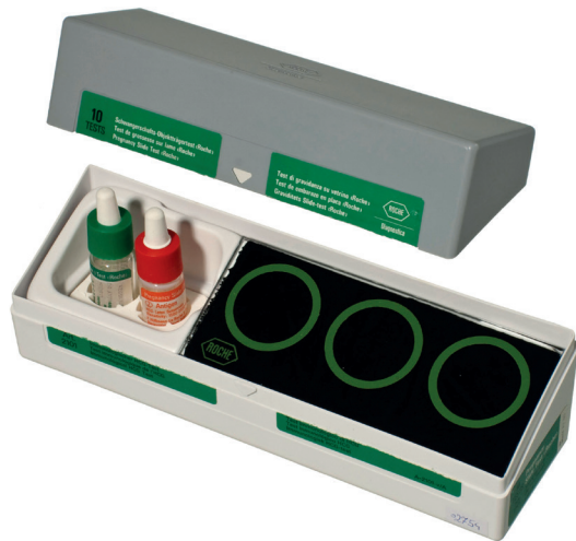
Abb. 4: Schwangerschafts-Objektträger-test Die Box der Firma Roche enthält ein grünes Fläschchen mit Anti-hCG Serum (Rabbit) sowie ein rotes Fläschchen mit hCG-Latex Suspension (Antigen). Eine schwarze Glasplatte mit aufgemalten grünen Ringen dient als Arbeitsfläche.
