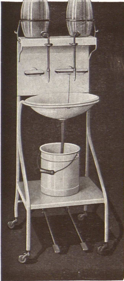
L. 400. Lavabo double, roulant. Bâti en tube d'acier soudé à l'autogène et monté sur roulettes caoutchoutées. Cuvette ovale en faïence, avec bonde à bouchon en cuivre nickelé, porte-savon, porte-brosse sur supports en cuivre nickelé, un seau de vidange à clapet, deux serre-tubes en cuivre nickelé actionnés par deux pédales. Deux barillets en verre de 5 litres ..... 660 »
