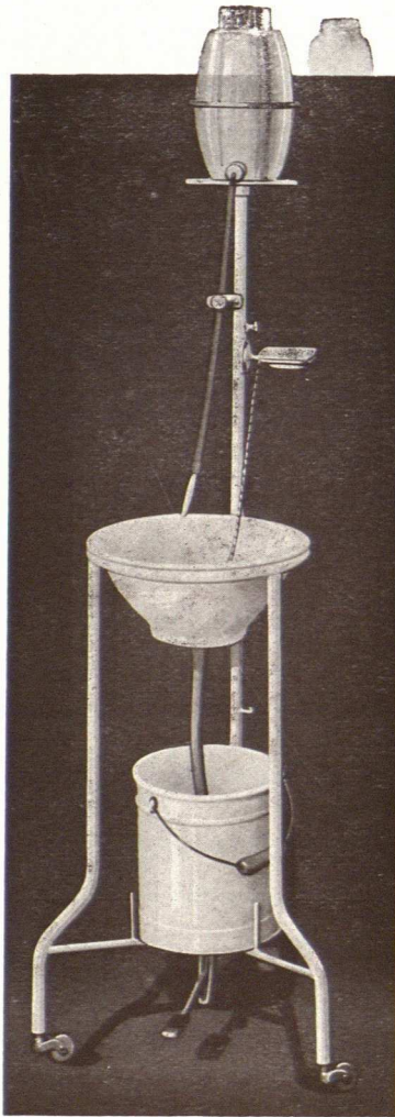
L. 410. Lavabo simple. Il est constitué par un bâti en tube d'acier monté sur roulettes caoutchoutées. Il est muni d'une cuvette en faïence de 33 cm. de diamètre avec une bonde à bouchon en cuivre nickelé, d'un barillet en verre de 5 litres avec robinet, serre-tube en cuivre nickelé actionné par pédale, d'un porte-brosse et d'un porte-savon sur supports en cuivre nickelé, d'un seau de vidange émaillé blanc avec couvercle à clapet... 450 »
