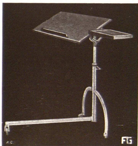
L. 470. Table pour malade au lit. Pied en tube d'acier monté sur roulettes caoutchoutées. Bâti métallique à élévation variable. Deux tablettes en bois contreplaqué ciré : l'une fixe horizontalement, l'autre s'inclinant selon les besoins du malade, pour le repas ou la lecture .... 275 »
