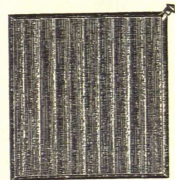
Fig. 72. Kautschuk-Stoffkissen mit Riefen und abgeteilten Feldern.
